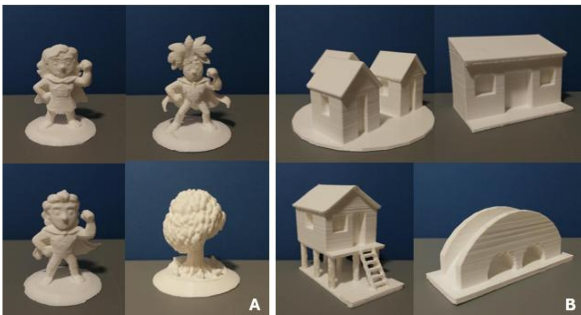
Figura 01 – Protótipos produzidos por manufatura aditiva: (A) modelos tridimensionais gerados com auxílio de Inteligência Artificial; (B) modelos desenvolvidos por modelagem tridimensional convencional. Fonte: autores.
