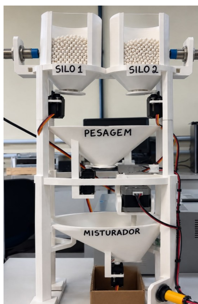
Figura 1 – Protótipo do misturador e dosador automático Fonte: Autores (2026)
